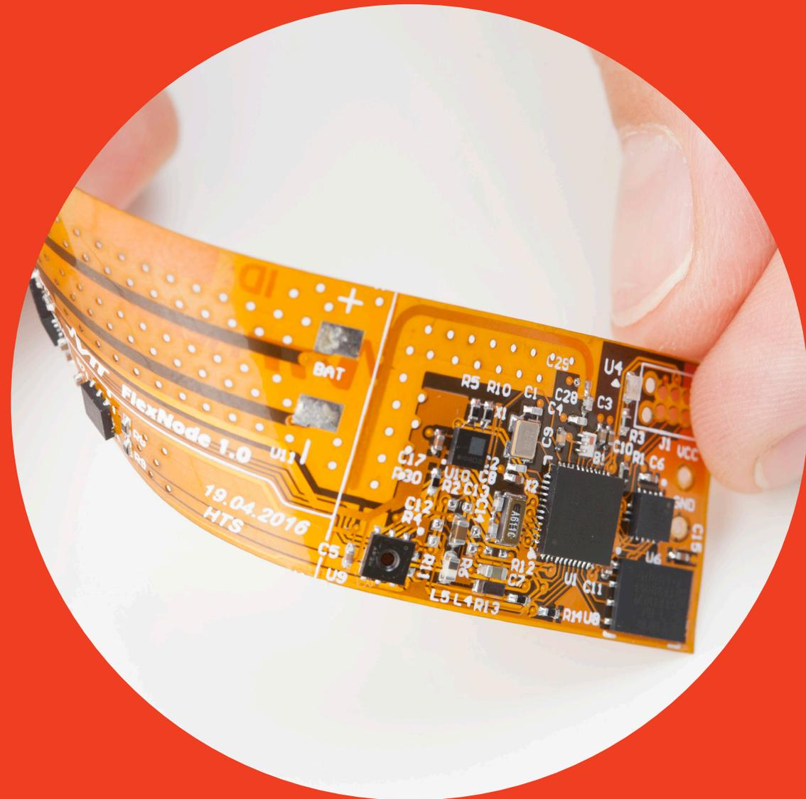
Gedruckte Elektronik gehört zu unserem Alltag: Teststreifen für Blutzuckermessgeräte, faltbare Displays, „intelligente“ Kleidungsstücke, Solarzellen und vieles mehr. Was einst als Chip aufgeklebt wurde, wird jetzt gedruckt.
